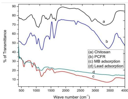
**Fig. 3. FTIR spectra of: (a) Chitosan (b) PCFR (c) PCFR-MB (d) PCFR-Pb(II)**
