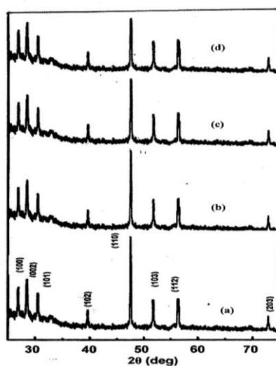
Figure.1 - XRD pattern of ZnS films deposited at different duty cycles (a) 6 % (b) 15 % (c) 33 % (d) 50 %
