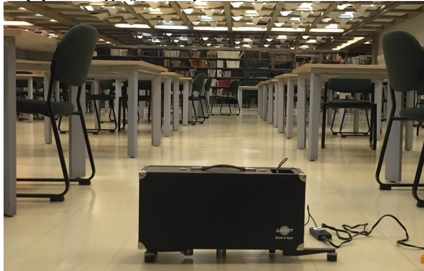
Figura 4: Equipamento tapping machine para medição de isolamento de ruído de impacto.
