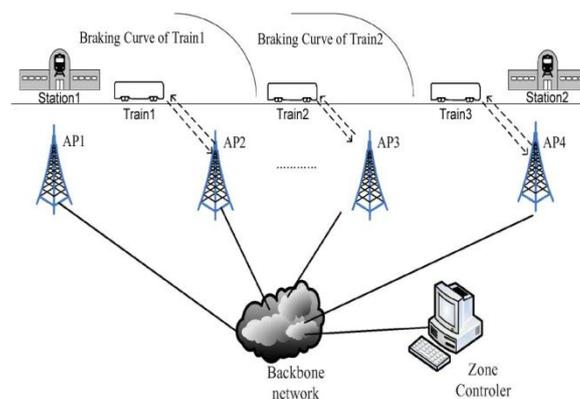
Fig: 1 ATC System Design
