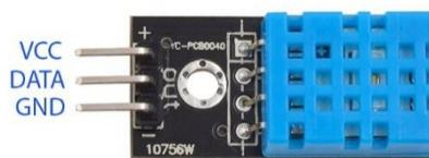
Figure 3. DHT-11 sensor
