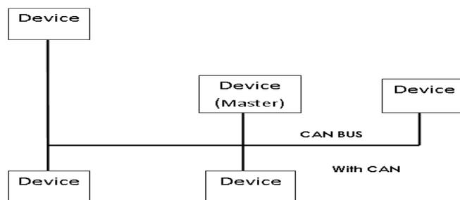
Fig. 2 (b) CAN Wiring
