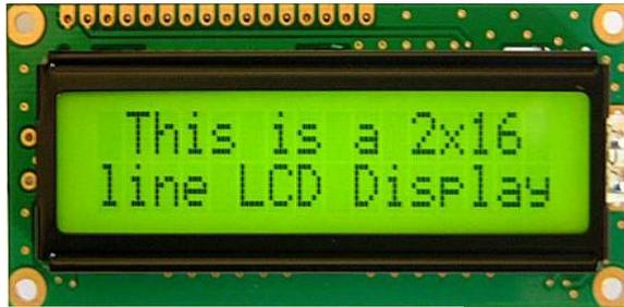
Fig. 5. LCD Display
