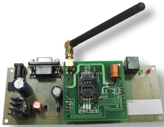
Fig. 2. GSM Module
