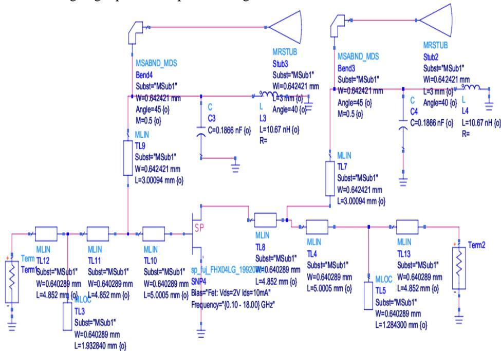
Fig. 7. Designed LNA
