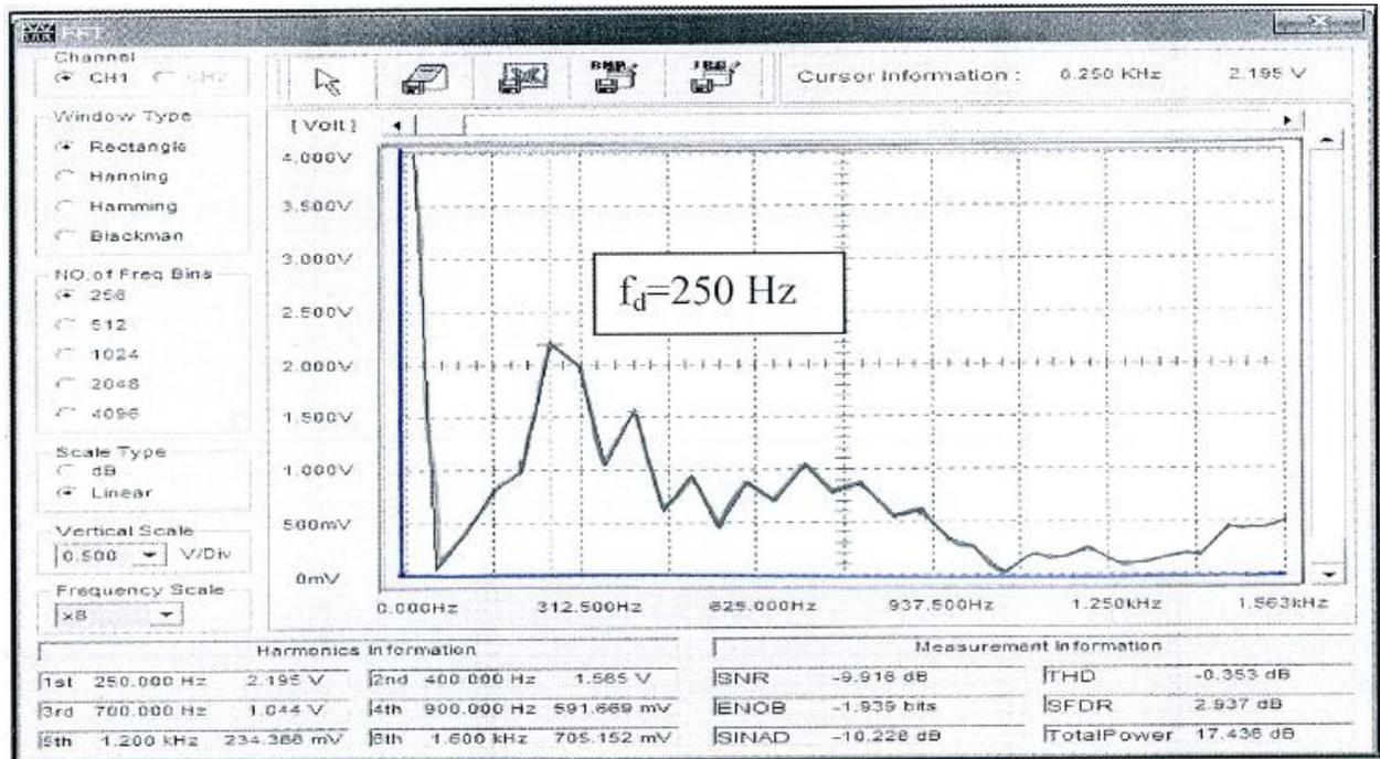
Figure 11: Frequency Response Spectrum of Steel Wood Sandwich Beam ( $h_f= 3\text{mm}$ ,  $h_c= 10\text{mm}$ ,  $B= 18\text{mm}$ , and  $L= 180\text{mm}$ )
