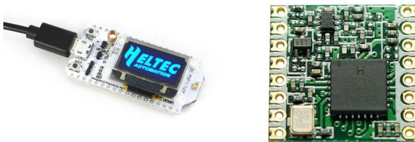
**Hình 2.** Module Heltec WiFi LoRa 32 và RFM98W
