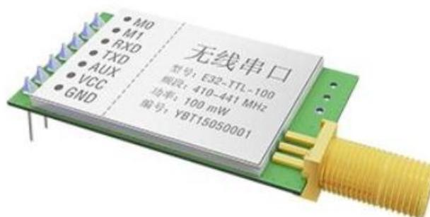
**Hình 3.** Module LoRa E32-TTL-100
