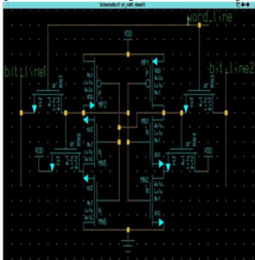
Fig. 4 ST-1 Bitcell schematic
