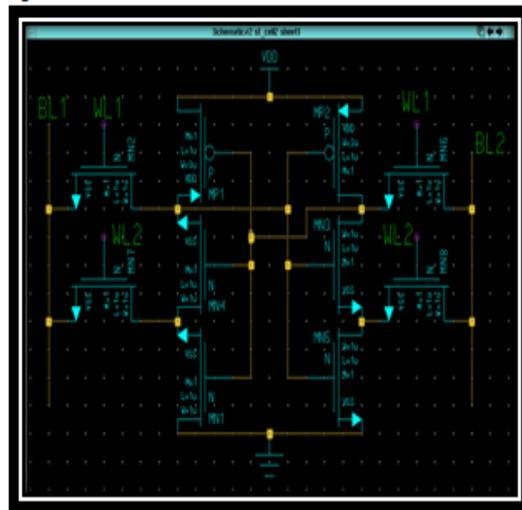
Fig. 5 ST-2 Bitcell schematic
