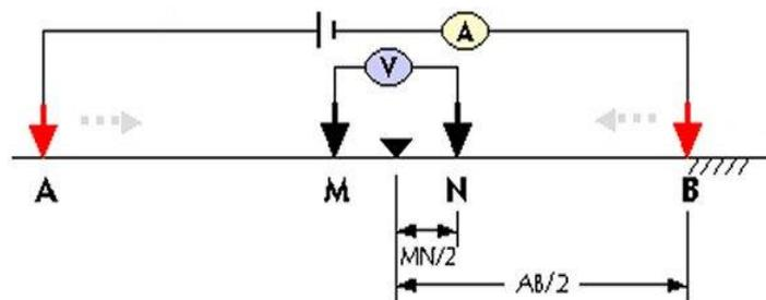
Figure 2.2: Schlumberger array (Zohdy et al. 1990)
