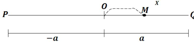
Le mouvement sinusoïdal est un mouvement de va et vient entre deux points  $P$  et  $Q$ . L'amplitude  $a$  est l'élongation maximale.  $a = \frac{PQ}{2}$ .
