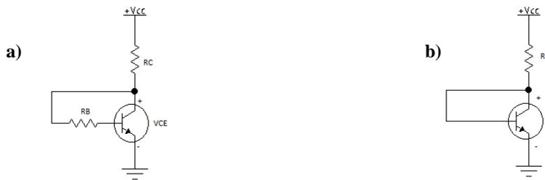
Figure 4 : Polarisation par réaction de collecteur : a) Circuit complet, b) Base court-circuitée au collecteur
