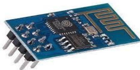
Fig.3. ESP8266 Wi-Fi Module
