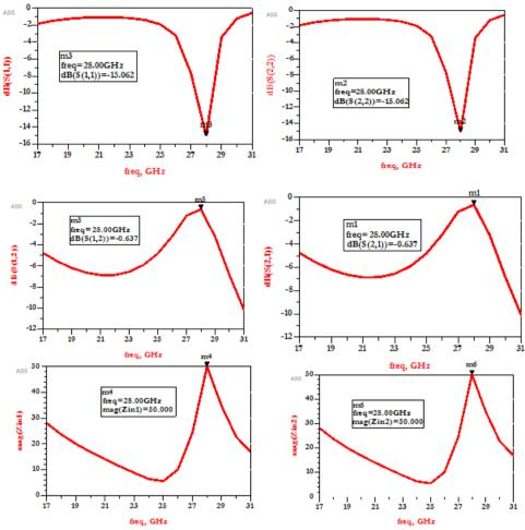
Figure 7: Stub S parameters
