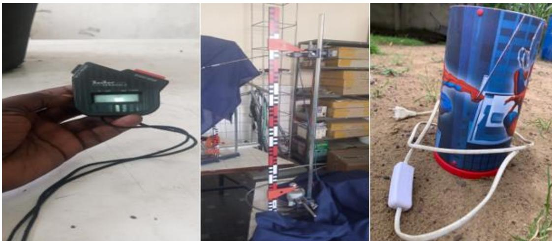
Figure 3. De gauche à droite : chronomètre, décamètre et flotteur utilisés dans cette étude
