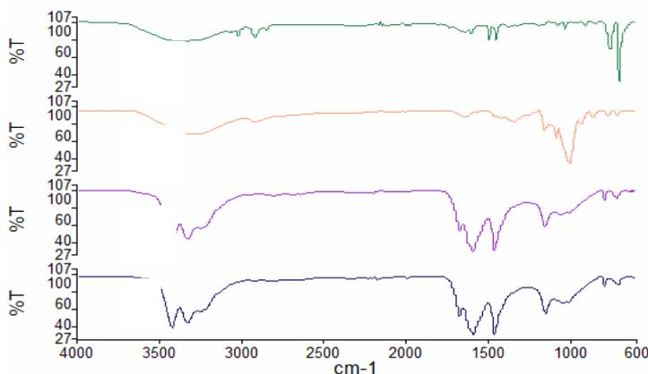
**Fig. 9. FTIR spectra of PS - Starch blend (d)<sup>31</sup>**
