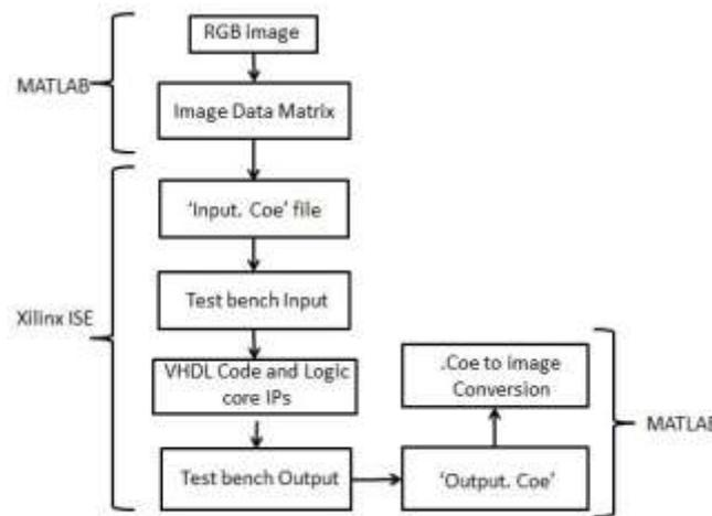
Fig. 7. Test Desgin Flow
